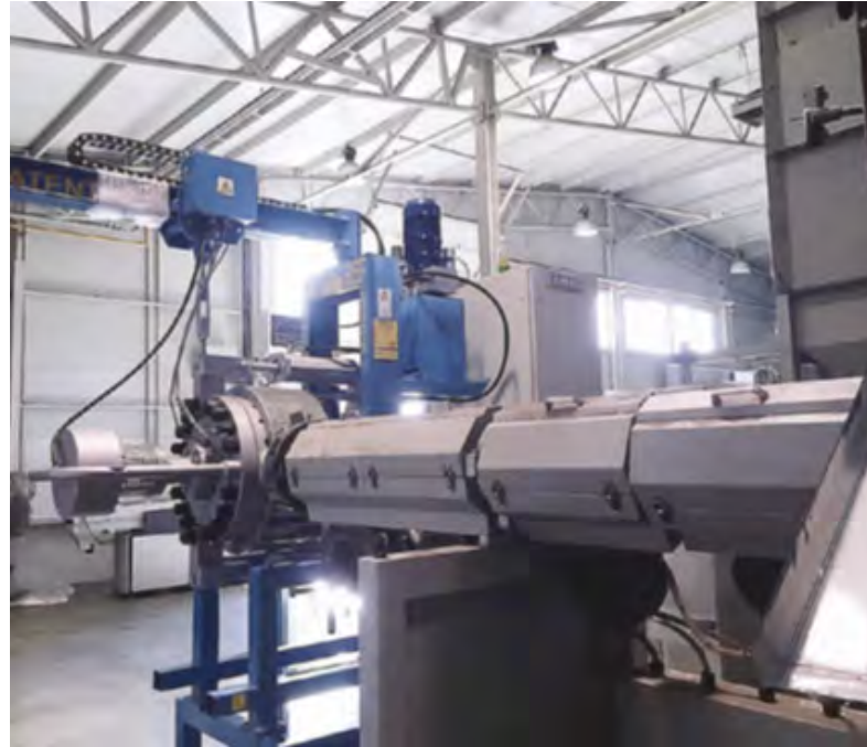
تست فیلتراسیون مذاب با استفاده از فیلتر مذاب RAS در ایتالیا
