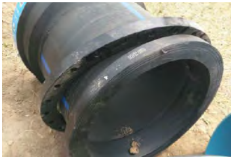
شکل ۱۲- تصویر فلنج و اتصال کوپل استفاده شده در پروژه
