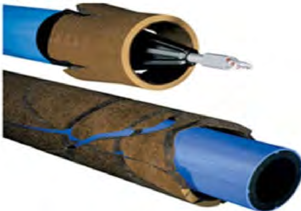
شکل ۲- روش شکافتن لوله بدون ترانشه
