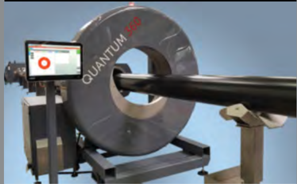
کوانتوم ۳۶۰ شرکت Inoex بر پایه پرتو Terahertz
