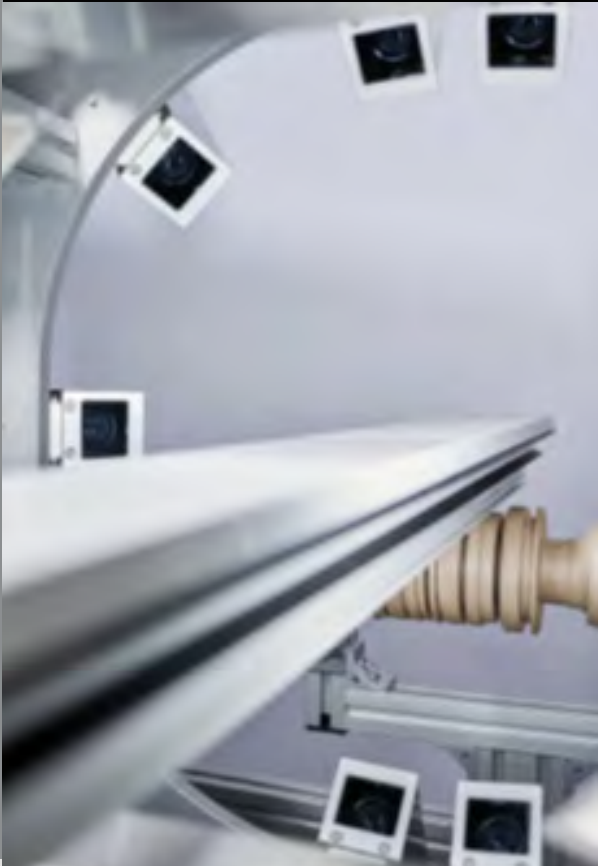
Pixargus DualVision XXL v ProfilControl متکی بر یک سیستم دوربین توسعه یافته و روش کالیبراسیون
