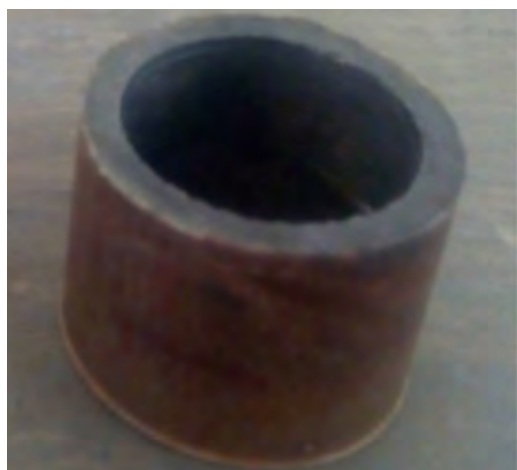
لوله کامپوزیتی PVC تقویت شده با ذرات ساقه موز
