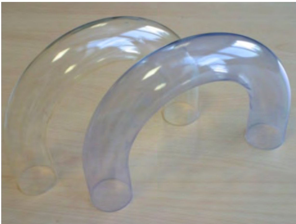
شکل ۳: خم لاشکل U-bend سایز ۰٫۵×۶۳ میلی متر با پایه گرید PVC-U شفاف مخصوص با شعاع d=2 = ۱۳۵ میلی متر برای PBR های لوله ای.
