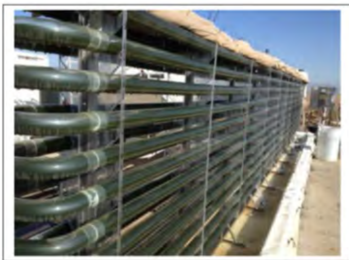
شکل ۶: راکتورهای نوع Gem-tube با ظرفیت ۷۵۰ لیتر بر پایه PVC-U شفاف با گرید ویژه، نصب شده در Synthetic Genomics، ایالات متحده آمریکا (چپ) و یک نمایشگاه بین المللی کشاورزی در سوئیس به عنوان نمایش تکنولوژی (راست).
