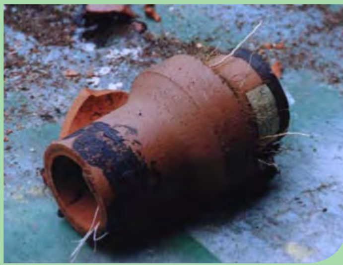
شکل ۹- اتصال رینگی VC که ریشه از طریق آب بند به درون لوله نفوذ کرده است
