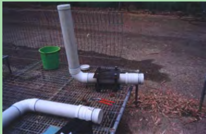
شکل ۱- نصب افقی با 7/5\% انحراف که به بخش نری از طریق ۲ صفحه فولادی موازی اعمال می شود
