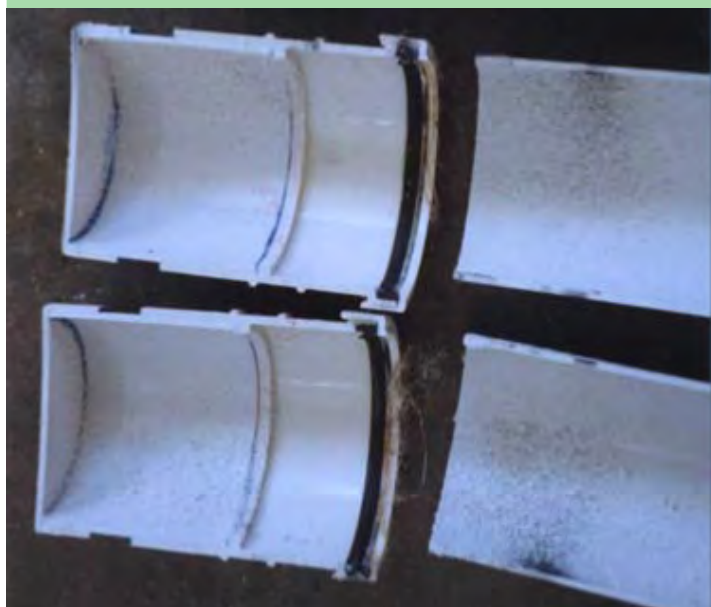
شکل ۸-مقطع عرضی PVC مونتاژ شده نشان می دهد که ریشه به درون اتصال نفوذ نداشته است
