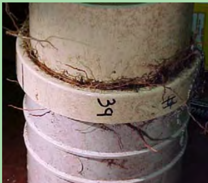
شکل ۷- رشد ریشه مالوکا در شکاف مادگی اتصالات PVC
