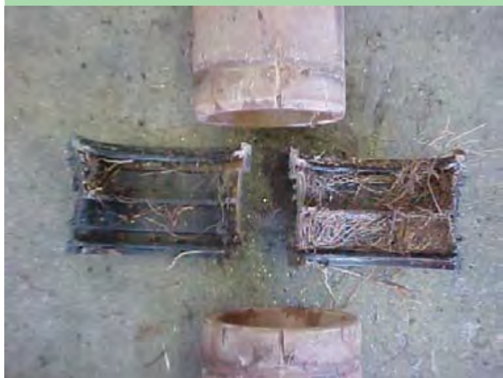
شکل ۱۰- اتصالات لوله VC با کوبلینگ پلاستیکی که نفوذ ریشه بالایی را نشان می دهد
